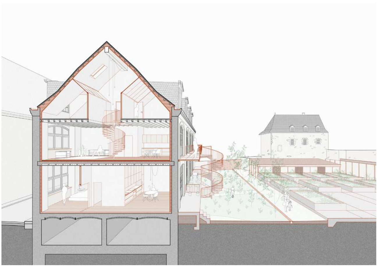
L'aménagement des logements, tous traversants, tire parti des volumes exceptionnels de la Manufacture La coursive rapportée distribue des logements duplex à l'étage
